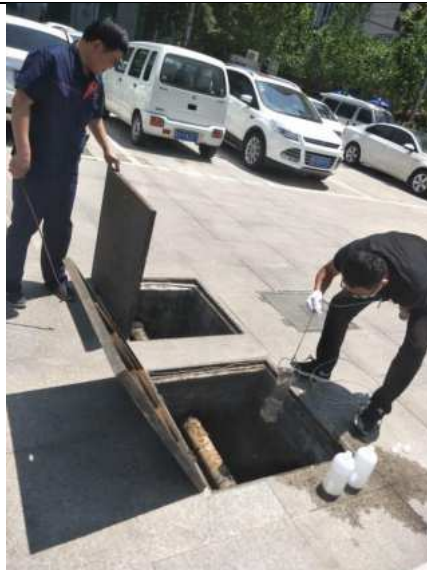
污水处理站进口采样照片
